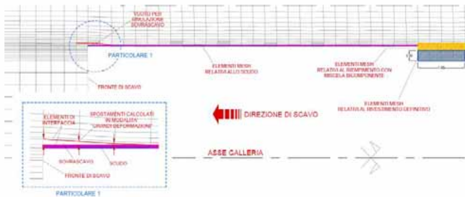
Figura 13 . Particolari della mesh di calcolo del modello numerico assialsimmetrico
