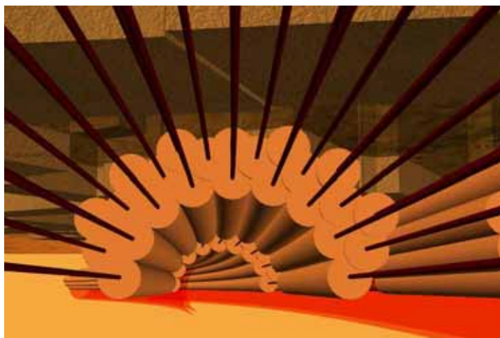
Figura 3 – Trattamento del terreno al contorno dello scavo
