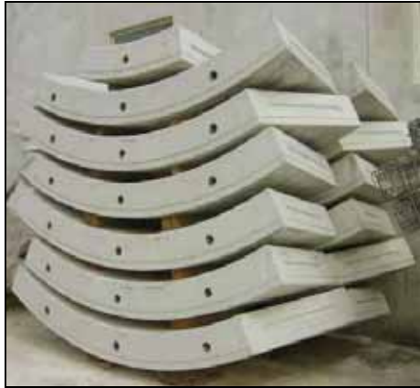
Figura 5 Conci prefabbricati del rivestimento definitivo (immagine a sinistra). Ubicazione delle barrette in un anello strumentato del rivestimento definitivo (immagine a destra).
