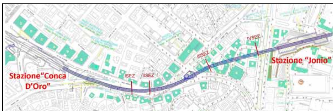
Figura 4 Ubicazione delle sezioni di monitoraggio "Genesi" lungo la galleria della Metropolitana di Roma Linea B1 "tratta Piazza Conca D'Oro – Piazzale Jonio".
