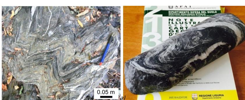
Figura 5: a) particolare dell'ammasso in affioramento; b) campionamento da foro di sondaggio
