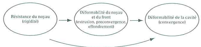
FIG. 7 Assurer la rigidité du noyau d'avancement signifie éviter les phénomènes d'instabilité du front et par voie de conséquence contrôler l'apparition de la réponse en déformation en amont de celui-ci et donc également son évolution en aval.
