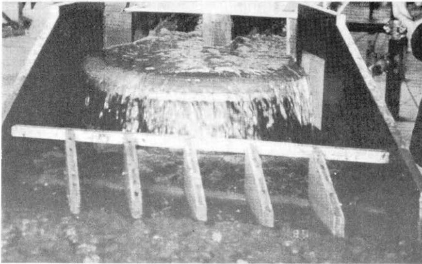
Fig. 9 - Modello idraulico: vista dell'opera di resa in alveo
