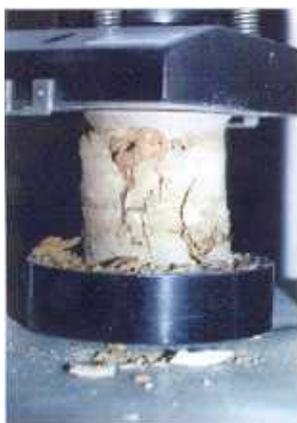
Foto 1: prova di resistenza a compressione monoassiale di un campione di terreno piroclastico trattato con calce
