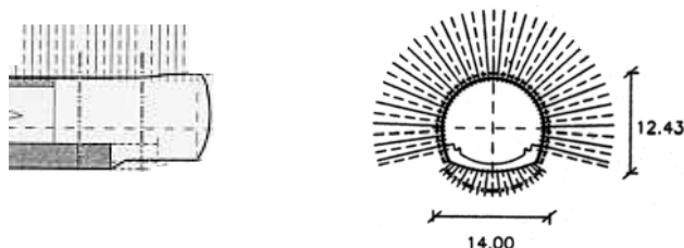
Fig. 8 – Sezione tipo B5 per l'attraversamento della faglia.
