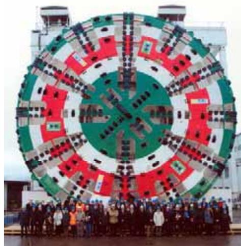
Figura 1. TBM EPB "Martina", Ø = 15,62 m
