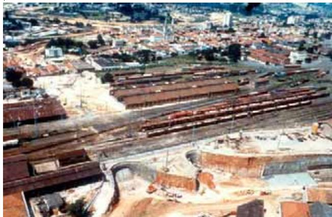
Figura 2. Proteção do núcleo-frente com jet-grouting horizontal à seção plena – Passagem subterrânea rodoviária do pátio ferroviário de Campinas ( $\varnothing = 14,9$  m, Terreno: areia, Cobertura 2 a 4 m)
