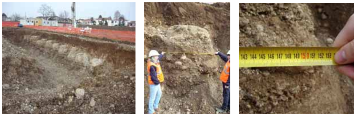
Figura 7. Campo prova jet "bifluido" (1500 mm)
