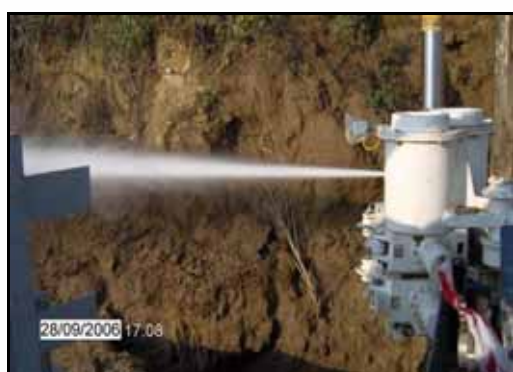
Figura 14b - A sinistra - conformatore getto con monitor ETJM - a destra con monitor "tradizionale"
