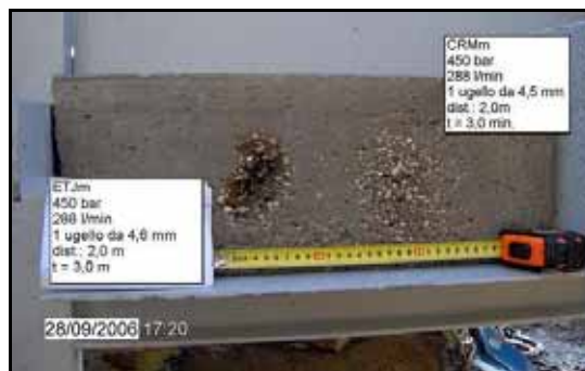
Figura 15 -Test di disgregazione con monitor ETJ e con monitor "tradizionale"
