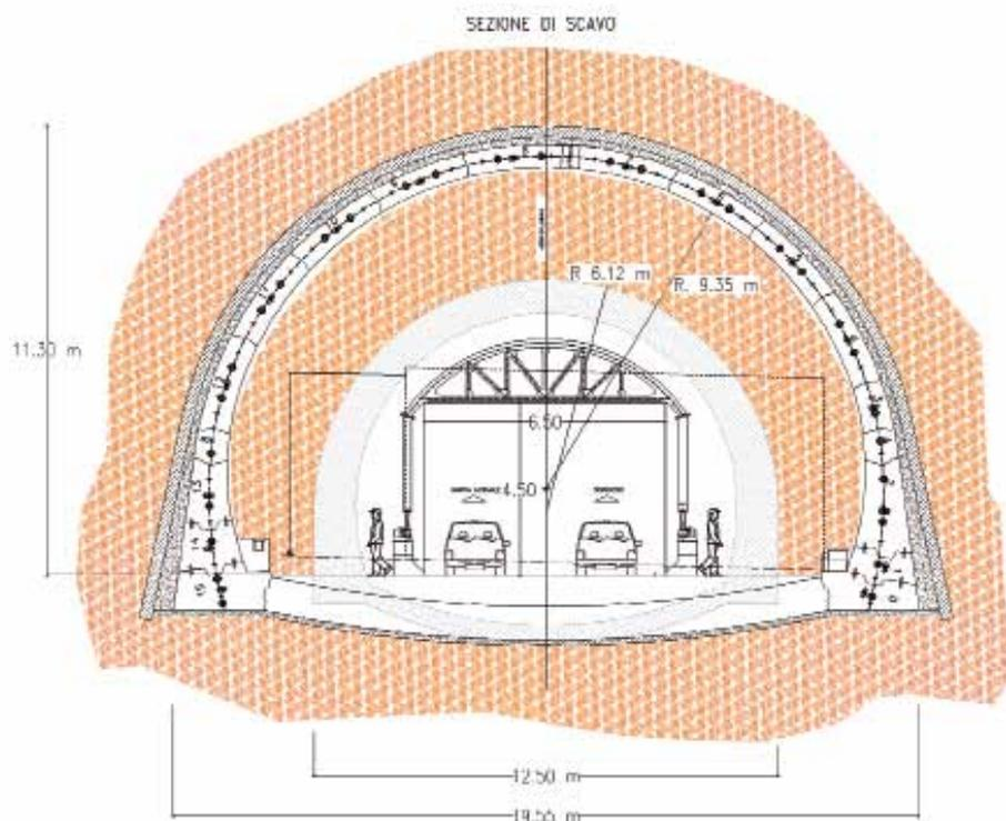
prensiva di arco rovescio, esclusa la galleria esistente, era pari a 158 m<sup>2</sup> ed il raggio interno è di circa 9,50 m.
