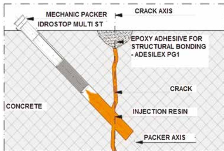
8. La procedura di sigillatura delle fessure
